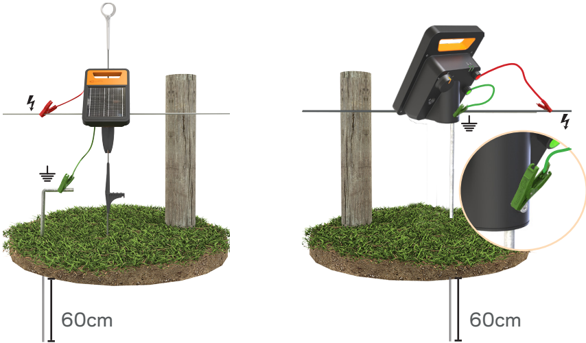
Erdung für Schritt 3 (a. b. c.)
