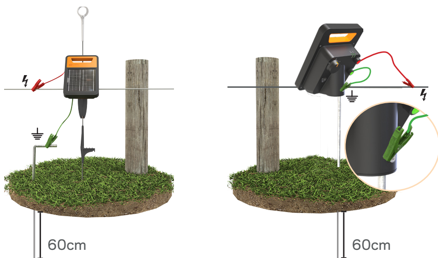
Aterramento para a Etapa 3 (a. b. c.)
